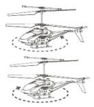
Drücken Sie den Steuerungshebel nach links und der Helikopter dreht sich nach links.
